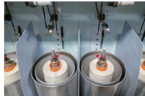
纱线速度传感器(选配装置) Speed sensor
