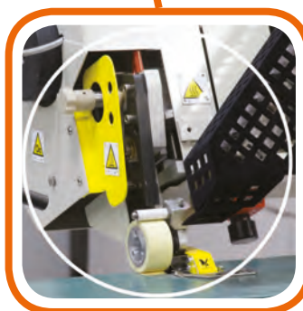
Guida regolabile e dispositivo dell'ugello anteriore Adjustable guide and front nozzle device
