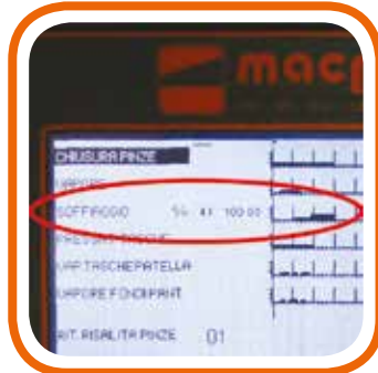
Regolazione quantità soffiaggio con inverter Blowing quantity regulated with inverter
